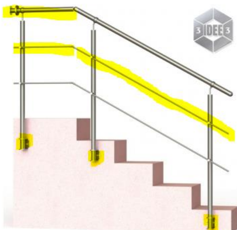
5. Mit Wandanker und Füllstäbe und Wandflansch und gerade oben
